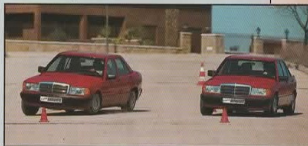
El resultado de una amortiguación más enérgica, la suspensión rebajada, una dirección más directa y un equipo de llantas y neumáticos más dimensionados, es el que se aprecia en la foto. El 190 equipado con la opción Sportline es mucho más neutro y eficaz en su paso por curva.
